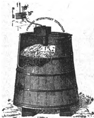
Fig. 32. — Tino munito di auto-versatore dell'acqua per il lavaggio metodico delle vinacce, sistema Bernard.
