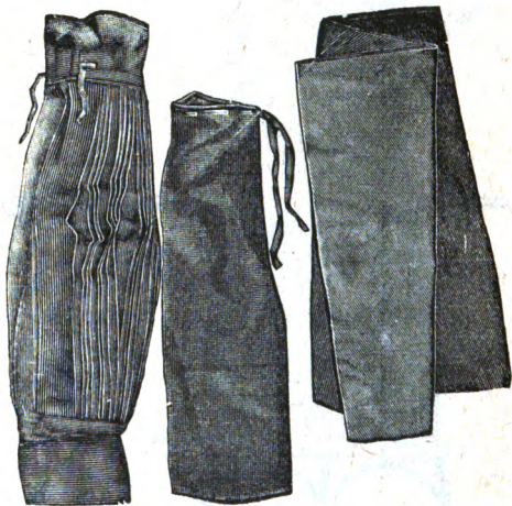
Fig. 15. — Forma dei sacchi di tela speciale adatti al filtro olandese a pressione per render limpido rapidamente il vino avuto dalla deposizione delle fecce e non ancora ben chiarito.
